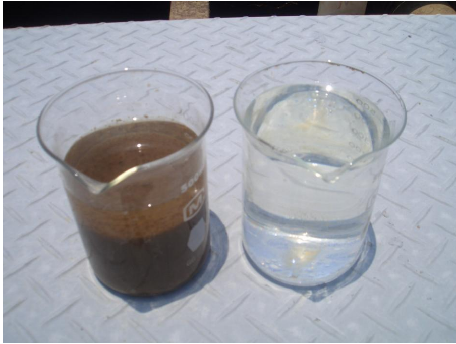
圖 7-3 MBR 放流水質外觀極為接近自來水。左邊為 MLSS 約 15,000mg/L 之良好沉降情況。
